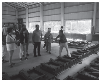
道路の側溝のコンクリート製の蓋製造
